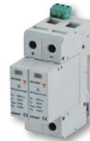
Proteja instalaciones mono y trifásicas (<550VCA) de voltajes transitorios, sobretensiones, descargas atmosféricas indirectas e interrupciones con este protector de sobretensión Type 2 Class C. El **DSF** es para sistemas CA con aprobación UL1449 3ª edición. No necesita fusibles por debajo de los 200kArms.
