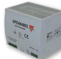
Esta serie trifásica está disponible con salidas de 120, 240, 480 o 960W, con voltajes de 12, 24 o 48VCD. Conexión vía entrada bifásica es posible con una degradación de potencia del 75%. Aprobación de instalación Class I, Division 2.
