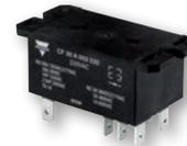
Relé con alta potencia en un diseño sellado para máquinas expendedoras y cargas de compresor. Capacidad de conmutación de hasta 30ACA. Aislamiento reforzado 4kV/8mm. Cumple con la construcción clase F.
