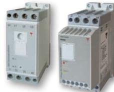
Arrancadores suaves de uso fácil para compresores scroll 2 y 3 fases hasta 45ACA (**RSBD**) y 32ACA (**RSBT**). Equipado con un algoritmo de auto-adaptación (patente pendiente) que automáticamente se adapta a cada compresor específico, asegurando óptima reducción de la corriente de entrada. Optimizan la disipación de calor de manera interna.
