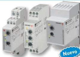
Controlador de nivel de dos puntos para dos niveles de llenado o vaciado. Ajuste de sensibilidad de 250Ω a 500KΩ. Montaje en riel DIN (CLD2) o conexión de 11 pines (CLP2). Alimentación de 24VCA/CD, 115VCA o 230VCA. El CL2EBU es de 240VCA/DC. Con hasta 2 salidas de 8A y LEDs diagnósticos.
