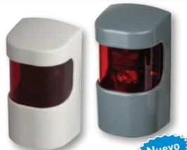
Cubierta elegante IP66 plástica o en aleación metálica en un sensor versátil retro-reflexivo polarizado desarrollado para sistemas automáticos de puertas. Detecta en una de tres direcciones al ajustar el ángulo de sensibilidad en la cubierta. Hasta 12m de rango, alimentación de 24VCA/CD y salida a relé.
