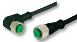
Cables IP67 PUR/PVC similares a los PVC pero con mayor flexibilidad y resistencia a la abrasión, químicos, aceites y otros lubricantes. Para sensores de CD. Disponibles en 2m y 5m. Algunos modelos incluyen opción de LEDs.
