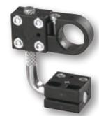
Herraje de montaje universal para cualquier sensor cilíndrico de Ø4 a Ø30mm. El adaptador incluye 2 cabezas de montaje (Ø18 y Ø30mm) y 5 casquillos adaptadores (Ø4, Ø5, Ø8, Ø12 y Ø14 mm).
