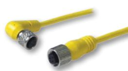
Cables IP67 en PVC disponibles en ángulo recto y L con conector M12. Para conexión con sensores de CA en 3 hilos. Disponibles en longitudes de 2 y 5m.
