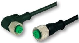
Cables IP67 de PVC, disponibles en ángulo recto y L con conector M12. Versiones de 3, 4 o 5 hilos para sensores de CD. Disponibles en 2m, 5m y 10m. Algunos modelos incluyen opción de LEDs.
