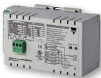
Arrancador suave para compresor tipo scroll de 1 fase con capacitor de arranque integrado. **RSBS** también está disponible en tamaño estándar 25A y alta presión 32A, esta última suministra una corriente dinámica limitante que asegura el arranque del compresor aun a presiones mayores de arranque con un límite máximo de corriente de 80ACA.
