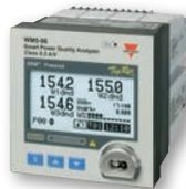
Analizador de calidad de potencia trifásico con capacidad de análisis de armónicas, montaje en panel. Unidad de display y módulos conectables como: alimentación, medición/entradas digitales, salidas análogas/digitales y puerto serie (ModBus, Ethernet).
