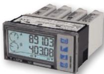
Display doble de 6 dígitos, 1/8 DIN, con doble indicadores análogos. Acepta dos entradas de pulsos CA o CD de hasta 50KHz y calcula velocidad, frecuencia y la relación entre ambas.
