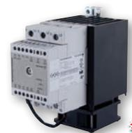
RES con control proporcional de salida. Este dispositivo controlado por microprocesador ofrece la flexibilidad de 6 modos de conmutación: ángulo de fase, distribuido (1, 4 o 16 ciclos de estallido) o arranque suave (seguido de 16 ciclos de estallido). Máx. corriente hasta 75A (**RGC2P**) y 65A (**RGC3P**), controlado por una de varias señales análogas.
