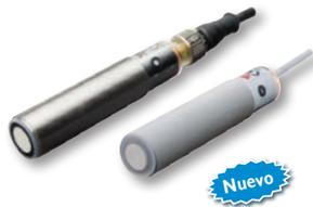
Sensor ultrasónico difuso multifunción M18 con cubierta IP67 en plástico PBT o acero inoxidable. Distancia de detección de hasta 2.2m. Dos salidas de transistor o una salida análoga + una digital. Conmutación estándar, histéresis ajustable o modelos ventana mediante calibración de botón. 2m de cable o conector M12.
