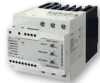
Controlador de motor de semiconductores compacto digital de CA para motores trifásicos jaula de ardilla de propósito general. Clasificado para 30Hp en conexión interna delta o 20Hp en conexión en línea. Este dispositivo no cuenta con relés de bypass internos pero incluye un contacto de relé para ayudar a energizar un contactor de bypass externo.
