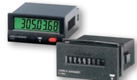
Series Electrónicas **FSA01** y **FSA02** tienen LCD de 8 dígitos en cubierta de 24x48 DIN. Modelos CA y DC, bloqueo de teclas, sincronización de 0.1s y batería de litio de 8 años. Las familias **E1HM4** (1/32 DIN) y **E2HM4** (1/16 DIN) son contadores mecánicos de horas tienen 7 u 8 dígitos ampliados y alimentación CA/CD.
