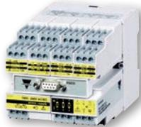
Transductor de 3 fases para entradas de potencia. Recomendado para medición de principales variables eléctricas. Montaje en riel DIN. Puertos de comunicación RS-485/RS232, puerto Ethernet, salidas de alarma y pulso opcionales.
