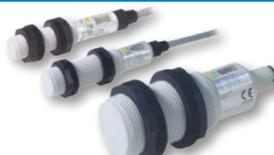
Sensores capacitivos tecnología Tripleshield™ y botón "teach". Rangos de sensado de hasta 8mm (M12), 12mm (M18) y 30mm (M30). Salidas de 4 hilos CD NPN o PNP NA/NC. Conexión por 2m de cable o conector M12. Compensación de humedad auto-detección NPN/PNP, calibración remota, salida de alarma. Compensación de polvo o humedad opcionales.
