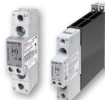
Tanto el **RGC1D** como el **RGS1D** tienen 17.5mm de ancho. El **RGC1D** tiene disipador de calor integrado soporta 15ACD a 40°C, mientras el **RGS1D** es un RES de montaje en panel que soporta 15ACD y 25ACD. Esta línea Premium de relés de estado sólido ofrece amperaje de hasta 1,000VCD.
