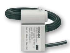
Sensor de corriente CA TRMS de núcleo partido para medir corrientes de 20-400ACA con señal de salida de 4-20mA CD proporcional a la corriente medida en el primario. Alimentación de 10-30VCD.
