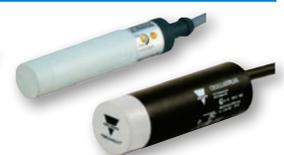
Sensores capacitivos con aprobación ATEX en CD o CA (Tripleshield™). Distancias de detección de hasta 12mm (Ø18) o 20mm (Ø32), montaje no rasante. Salidas NA o NC con retardos a la entrada o salida (modelos CA), PNP o NPN con salida NA o NC (modelos CD). Ideales para detección de granos o sólidos en tanques, silos o contenedores en zonas ATEX 200 o 22.
