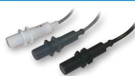
Sensores capacitivos tecnología Tripleshield™. Distancia de detección ajustable de 3-8mm (M12), 12mm (M18) y 30mm (M30). Salidas de 4 hilos CD NPN o PNP NA/NC. Conexión por 2m de cable o conector M12. Compensación de humedad auto-detección NPN/PNP, calibración remota, salida de alarma. Compensación de polvo o humedad opcionales.
