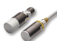
Sensor inductivo de proximidad M18 en acero inoxidable, latón niquelado o plástico con cubierta IP67. Versión estándar y de rango extendido hasta 14mm de sensado. Salidas NAMUR, 2 hilos CA, 2 hilos CD y 3 hilos CD. Montajes rasante, cuasi-rasante y no rasante. Método de conexión: cable 2m o conector M12.
