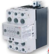
Los productos de dos y tres polos son contactores de estado sólido, usados en conmutación frecuente. Valor máximo nominal de 32ACA a 25°C. Protección MOV y de supresores estándar. Interruptor de sobrecalentamiento interno estándar en la versión de 32ACA, opcional en los tamaños menores.
