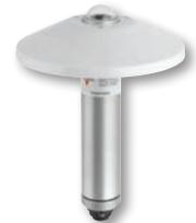
Sensor de radiación solar global basado en transductores termopila que cumplen con estándares de la WMO (Organización Meteorológica Mundial). Certificado de calibración mundial. Irradiación solar de hasta 2,000W/m<sup>2</sup>. Salida de 4-20mA proporcional a la irradiación solar.
