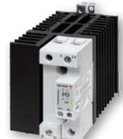
Línea de potencia del **RGC** con salida máxima nominal de 90ACA/15Hp a 40°C. La versión de 60ACA/10Hp utiliza métodos convencionales de enfriamiento, mientras que la de 90ACA /15Hp necesita un ventilador integrado. Protección MOV estándar. 100kArms SCCR UL508.
