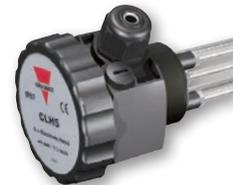
Varillas modulares de sensado de nivel para control de llenado/vaciado. Se utilizan con el controlador CLD. Se puede utilizar hasta con cinco electrodos (pueden ser aislados), con prácticamente cualquier longitud. Electrodos disponibles en Kynar (PVDF) y poliolefina (FR).
