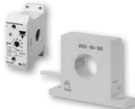
Medición compacta de corriente CA con 7 rangos seleccionables hasta de 50ACA y orificio de 12mm. También en versión con cable tipo **A82** en rangos primarios de 25, 50, 100, 250 y 500ACA. Rango primario con salida de 4-20mA o 0-10V. Orificio de 27mm.
