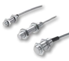
La **Serie IA..HT-K** de sensores de alta temperatura en M5, M8, M12, M18 y M30 de acero inoxidable o latón niquelado con cubiertas IP67. Resisten temperaturas de -40°C a 120°C (-40°F a 248°F). Rangos de sensado hasta de 15mm. Salida en 3 hilos CD. Montaje rasante o no-rasante. Conector M12 o 2m de cable.
