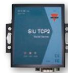
Puerto compacto de EtherNet a Modbus RS232/485. Configuración fácil por software. Montaje en pared o riel DIN. Comunicación serial a alta velocidad hasta 230.4Kbps. Alimentación 9 a 30 VCD, ADSV1A: CA/CD. Adaptadores disponibles.
