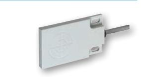
Sensor capacitivo de nivel de 3 hilos CD con colector abierto y salida a transistor NPN o PNP. Distancia de detección fija y detección a través de paredes no metálicas de hasta 25mm de grosor. Ideal en la detección a través de tubos.
