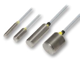
La **Serie IA..F** de sensores de proximidad inductiva con cara metálica en M8, M12, M18 y M30 en cubiertas IP67 de acero inoxidable. Los rangos estándar alcanzan hasta 15mm. Salidas de 3 hilos CD. Montaje rasante y no-rasante. Conector M12 o 2m de cable. Estos sensores son más resistentes a la abrasión e impacto.
