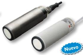
Sensor ultrasónico difuso multifunción M30 con cubierta IP67 en plástico PBT o acero inoxidable. Distancia de detección de hasta 3.5m. Dos salidas de transistor o una salida análoga + una digital. Conmutación estándar, histéresis ajustable o modelos ventana mediante calibración de botón. 2m de cable o conector M12.
