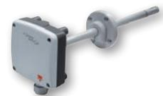
Este elemento de sensado de CO<sub>2</sub> usa NDIR (tecnología infrarroja no dispersiva). Con rangos de medición de 0-2,000 y 0-5,000 ppm correspondientes a salidas análogas de 0-10V o 4-20mA.
