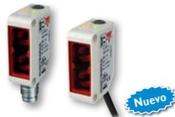
Sensores de rango completo compactos y de cubierta plástica reforzada. Una solución ideal para detección de alta precisión y tamaño pequeño son requeridos. Con potenciómetro superior o posterior ajustable. Tipos: difuso, retro-reflexivo, barrera. Disponible con: Polarización, arreglo APS CMOS, supresión de fondo y detección de objetos transparentes.
