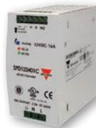
Salida de potencia ajustable. Versiones de 10A (24VCD) y 16A (12VCD). Cada una con entrada universal de CA y capacidad de 150% de carga pico y corrección activa del factor de potencia. Salida de potencia lista, función paralela y eficiencia de 93%.
