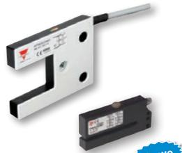
Sensores herradura con diferentes tamaños de ranura: el **PF80** angosta (3mm) es ideal para detección de etiquetas, el **PF74** de ranura ancha (30mm) es ideal para aplicaciones de elevador. De 3 o 4 hilos en CD e índice IP65.
