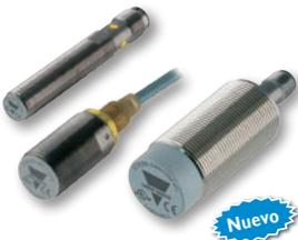
La **serie ICB** con distancia de sensado extra extendida en modelos M12, M18 y M30 de latón niquelado y cubiertas IP67. Los rangos extra extendidos llegan a 10mm (M12), 20mm (M18) y 40mm (M30). Salida de 3 hilos en CD. Montaje cuasi-rasante o no-rasante. Opción de conexión de 2m de cable o conector M12.
