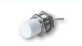
Sensores capacitivos de proximidad para aplicaciones de temperaturas extremas. Rango de operación a temperaturas de -196°C a 180°C (-321°F a 356°F). Rango de sensado 4-15mm (no-rasantes). Salidas NPN o PNP NA/NC. Ideal para secadoras o mezcladoras en la industria plástica.
