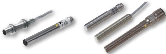
Sensores miniatura inductivos de proximidad. Rangos de detección de hasta 1mm. Opción NAMUR o 3 hilos CD. M5 Roscados o 6.5mm planos de diámetro en acero inoxidable, cubierta IP67. Rasante o no-rasante. Opción de cable 2m o conector M8.
