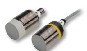
Sensor inductivo de proximidad M30 en acero inoxidable, latón niquelado o plástico con cubierta IP67. Versión estándar y de rango triple hasta 22mm de sensado. Salidas NAMUR, 2 hilos CA, 2 hilos CD y 3 hilos CD. Montajes rasante, cuasi-rasante y no rasante. Método de conexión: cable 2m o conector M12.
