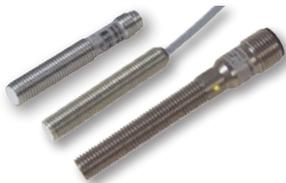
Sensor inductivo de proximidad en cubierta M8 de acero inoxidable, IP67. Rangos de sensado estándar y extendidos de hasta 4mm. Opciones NAMUR, 2 hilos de CD y 3 hilos de CD. Montaje rasante y no-rasante. Conexión a elegir entre cable de 2m, o conector de M8 o M12.
