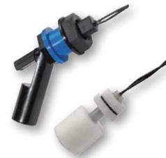
Interruptores de flotador de nivel utilizan un magneto embebido en un flotador para abrir o cerrar el interruptor. Las opciones incluyen tanto interruptores montados de tipo vertical como horizontal, en múltiples tamaños y con opción de estar hechos en acero inoxidable o encapsulados plásticos.
