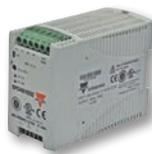
No se necesita un transformador de control de voltaje gracias a la entrada de alto voltaje bifase de este modelo (380-575 VCA). Esta fuente suministra 100W de potencia a 24VCD. Aprobación de instalación Class I, Division 2.
