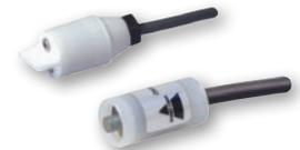
Varillas conductoras de sensado para control de nivel. Varilla suspendida para control de un punto (ej. piscinas). Conexiones de cable en neopreno. El A94 tiene dos varillas en una parte separadas por una barrera aislante de poliéster. Las funciones de detección se determinan según el amplificador usado.
