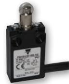
Interruptor de final de carrera miniatura con espacio de orificios de 20mm. Pre-cableado con 1m (3.3 ft) de cable. 15 opciones diferentes de actuador, 2 modelos diferentes de bloqueo de contacto. Disponibles en cubierta plástica o metálica. Totalmente sellado con índice IP67.
