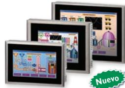
Cubierta IP65 de aluminio durable de 7, 10 y 15" con opción a IP66K en acero inoxidable. 65,536 colores, procesador de 1GHz, 128 MB ROM, 256 RAM, puerto USB, 2 puertos seriales, tarjeta SD, opción a 2 puertos Ethernet. Tarjetas de sonido y red disponibles. Alimentación de 11-36VCD pero opcional a 90-250VCA. Plataforma WinCE 6.0 Core.
