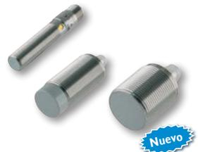
La **serie ICS** para ambientes hostiles en tamaños M12, M18 y M30 con cubiertas de Acero inoxidable, IP69-K y certificación ECOLAB, soportan de -40°C a 80°C (-40°F a 176°F). Con rangos de sensado de hasta 22mm. Salida de 3 hilos en CD. Montaje rasante o no-rasante. Conector M12 o con la **Serie CONB** IP69-K.
