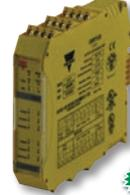
El monitor de velocidad CERTUS monitorea y controla velocidad cero, máxima velocidad, así como rango y dirección. Hasta 4 rangos de velocidad configurables para dos salidas de control y dos ejes independientes.
