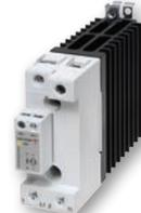
El **RGC** de tamaño medio con disipador de calor integrado 35.5mm de ancho. Corriente nominal de 40ACA a 40°C y voltajes de hasta 600VCA. Valor nominal alto de I2t de 6,600A2s está disponible en una versión RGH especial. Tanto el diseño del contactor (E) como el del RES (U) están disponibles.
