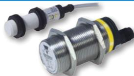
Sensores capacitivos tecnología Tripleshield™. Versiones 20-250VCA y 20-250VCA/CD (sólo M30 CA30..CLN..CP). Cubiertas IP67 en PBT y acero inoxidable disponibles. Sensado hasta 15mm (M18) o 25mm (M30), salidas NA y NC. Conexión por 2m de cable o conector M12. 4 hilos CD también disponibles en cubiertas de acero inoxidable (EC30..NASI)
