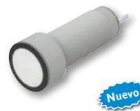
Sensor ultrasónico difuso multifunción M30 con cubierta IP67 en plástico PBT con cabeza de Ø40mm que sobresale 20mm. Distancia de detección hasta 6m. Dos salidas de transistor o una salida análoga + una digital. Conmutación estándar, histéresis ajustable o modelos ventana mediante calibración de botón. 2m de cable o conector M12.
