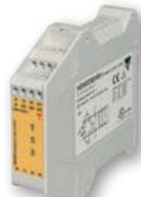
Relé de seguridad de propósito dedicado diseñado para aplicaciones de paro de emergencia Categoría 4. 2 salidas NA (NES02) o 3 NA de seguridad + 1NC auxiliar (NES13). Versión automática/manual y disponible con reset de monitoreo manual.
