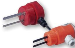
Varillas de sensado de nivel para control de llenado y vaciado de líquidos conductivos. Se usa con controladores CLD, incluye hasta cuatro electrodos (pueden ser aislados) de 1m de largo que se cortan según la necesidad. Cubiertas disponibles en nilón (VN), PVC (VPC), polipropileno (VPP), acero inoxidable (VS) y teflón (VT).
